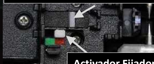
Fijador cable Holgado
